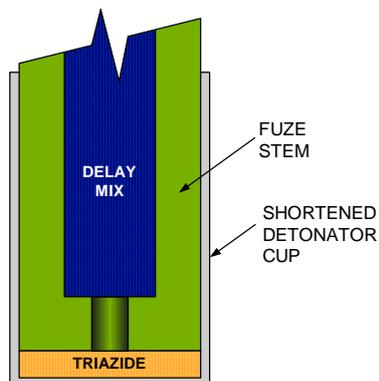
Figure 5: Delay-Triazide Test
